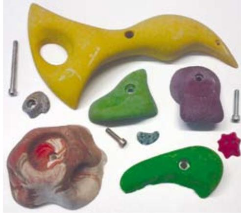
Neu ist hingegen eine Biegeprüfung bei Hohllage an der Wand, je nach Griffgröße sind Prüfkraften von 2, 5 oder 8 kN am Bolzenloch vorgeschrieben. Bei der Kennzeichnung, nunmehr ab 100 g, kommt das Herstellungsquartal hinzu.
